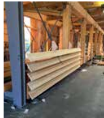
Fertigung des Stahlbaus, Vormontage der Segmente und Anbringen der Lamellen © Schmees & Lühn Holz- und Stahlingenieurbau GmbH & Co. KG
